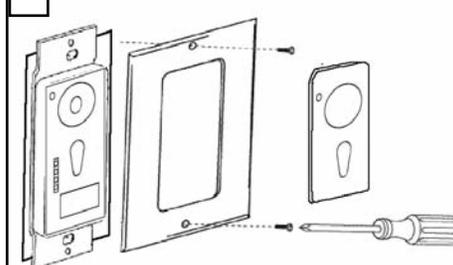
5 Attachez le couvercle d'interrupteur avant à l'interrupteur de commande murale à l'aide des vis fournis à cet effet.
