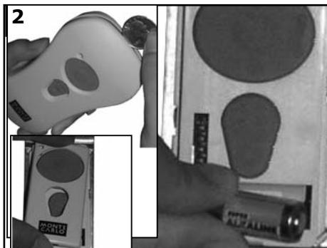
2 Enlever le couvercle en désengageant le haut ou le bas. Installer une pile de 12 volts dans la télécommande murale, marque Duracell MN21 / Eveready A23 / GP 23A.
