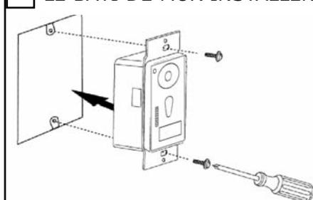
4 Reliez l'interrupteur de commande murale à la boîte de sortie de courant à l'aide des vis mécaniques fournis à cet effet.
