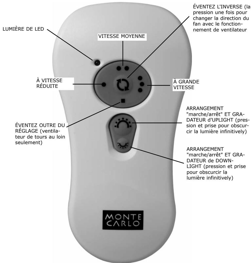
**La VITESSE de VENTILATEUR diminuent "1 point" pour à vitesse réduite, "2 points" pour le milieu ou "3 points" pour la haute. Pour tourner le ventilateur outre de la place de pression ".**
